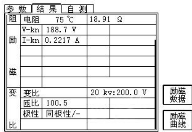
图 2.9 P 级 PT 的试验结果界面
